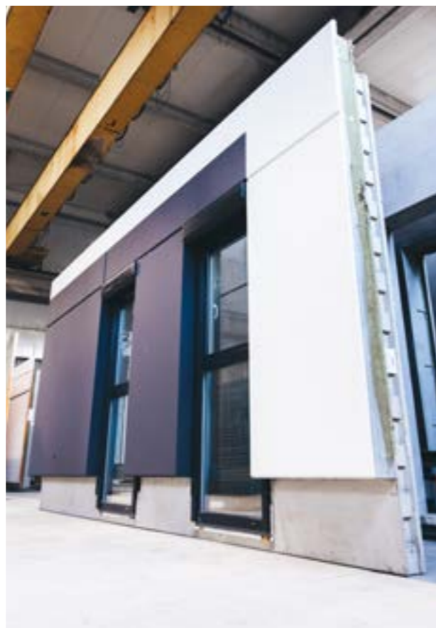
Ściana prefabrykowana trójwarstwowa, Poznań
